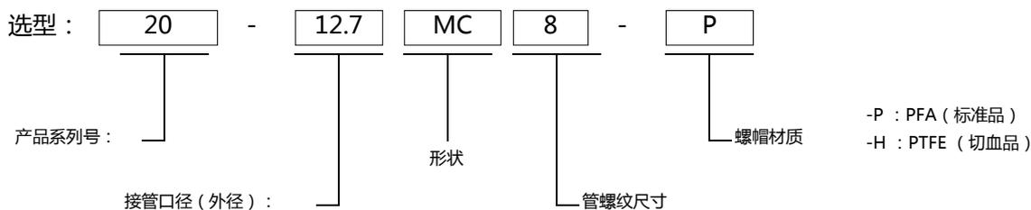
型号描述：一端入珠连接12.7\*9.5mm直管、另一端R1/2"螺纹接头
